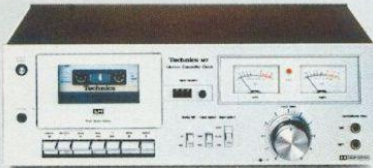
RS-M 7 Cassettendeck mit Dolby. CrO 2 /FeCr-Umschaltung. Frontbedienung. Super-Permalloy-Tonkopf. Übertragungsbereich 30 – 14.000 Hz (DIN) bei CrO 2 . Gehäusefarbe: Silber.
